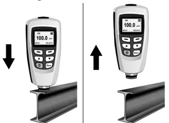
Das Gerät bei der Messung möglichst gerade, tangential und ruhig halten.
