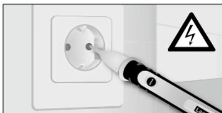
При наличии напряжения щуп загорается, и звучит акустический сигнал.
