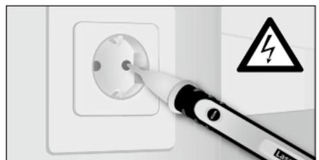
In presenza di tensione la punta si accende e viene emesso un segnale acustico.
