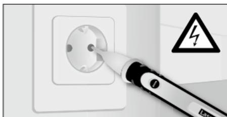
Hvis der findes spænding, lyser detektorspidsen, og der lyder et signal.
