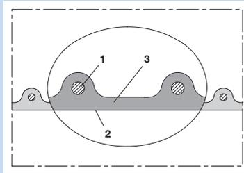
Antistatischer Polyurethanschlauch, schwer, mikrobenfest + schwerentflammbar
