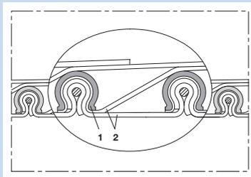
Hochtemperaturschlauch, Klemmprofilschlauch, mehrlagig, isolierend, geeignet für leichten Überdruck (bis +550°C)
