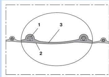
Antistatischer Lebensmittelschlauch und Pharmaschlauch, leicht, Edelstahldraht (INOX)
