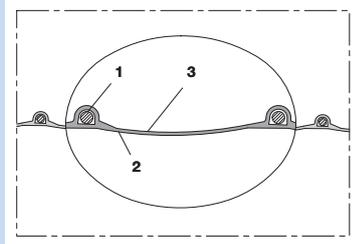
Antistatischer Polyurethanschlauch für die Holzindustrie, leicht, schwerentflammbar
