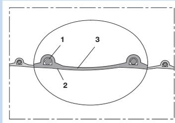
Antistatischer Polyurethanschlauch für die Holzindustrie, mittelschwer, schwerentflammbar
