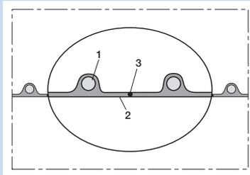
Antistatischer Polyurethanschlauch, leicht, mikrobenfest + schwerentflammbar, Erdungslitze
