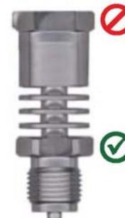
Montage d'un élément de refroidissement
