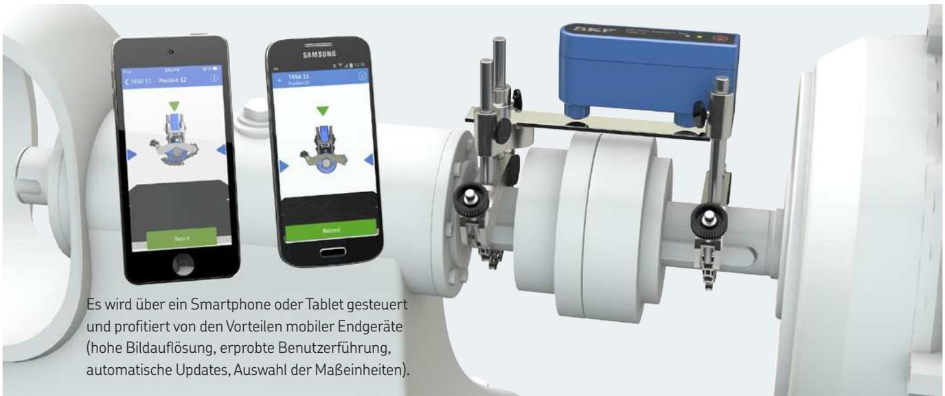
Es wird über ein Smartphone oder Tablet gesteuert und profitiert von den Vorteilen mobiler Endgeräte (hohe Bildauflösung, erprobte Benutzerführung, automatische Updates, Auswahl der Maßeinheiten).
