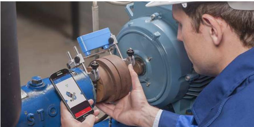
Eine Wellenausrichtung lohnt sich für eine Vielzahl von rotierenden Industriemaschinen. Oft erlaubt die Ausrichtung eine deutliche Verbesserung der Maschinenverfügbarkeit bei gleichzeitiger Reduzierung der Instandhaltungskosten. Das TKSA 11 ist in erster Linie für Industriebranchen geeignet, in denen bislang keine Wellenausrichtung erfolgt.
