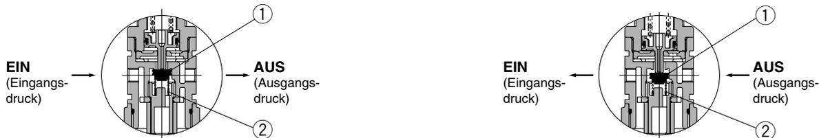
Ist der Eingangsdruck höher als der Ausgangsdruck, arbeitet der Regler normal (Abb. 1).
