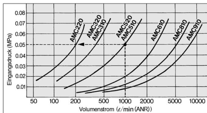
Lesen des Diagramms: Wenn das Modell AMC510 mit einem Volumenstrom von 1000 l/min (ANR) betrieben wird, beträgt der Eingangsdruck 0.05MPa.
