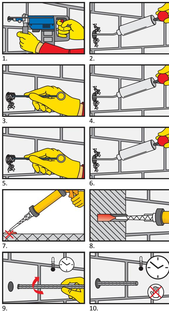
1. Mit einem elektrischen Schlagbohrer ein Loch in gewünschtem Durchmesser und Tiefe in den Untergrund bohren. Bohrlochdurchmesser muss der Ankergrösse entsprechen.
