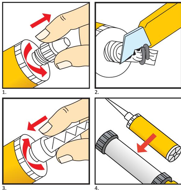
1. Verschlusskappe abschrauben und entfernen.
