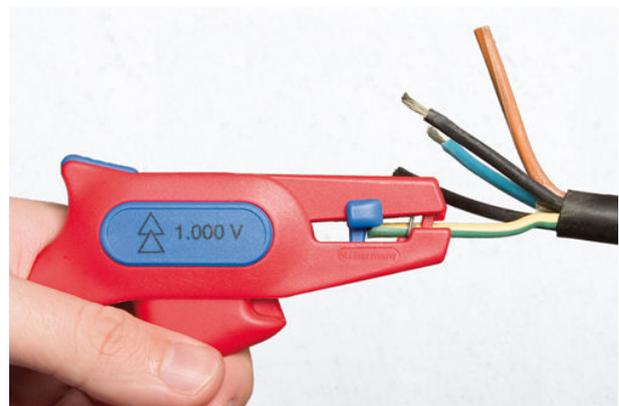
Die WEICON-Abisolierzange No. 6 verfügt über einen verstellbaren Längenanschlag von 5 – 12 mm. Dadurch werden alle flexiblen und massiven Leiter von 0,2 – 6,0 mm<sup>2</sup> (24 – 10 AWG) abisoliert. Der Längenanschlag kann bei Bedarf herausgenommen werden. Dieses vollisolierte Werkzeug unterliegt der Stückprüfung gemäß VDE-Vorschrift nach IEC 60900:2004, und hält einer Spannung von 1000 Volt stand.
