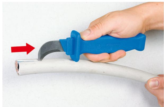
Das Kabelmesser HD No. 1000 ist sehr robust und ermöglicht ein präzises, schnelles und sicheres Abmanteln besonders dicker Kabeltypen. Die verschiedenen Lagen bei mehrfach isolierten Kabeln kann man mit dem HD No. 1000 problemlos aufschneiden. Die gebogene Klingenspitze begrenzt die Schnitttiefe und verhindert so eine Beschädigung der Leiter. Das Messer ist nach VDE-Vorschrift IEC 60900:2004 für Arbeiten an unter Spannung stehenden Leitern geprüft und hält bis zu 1000 Volt stand.
