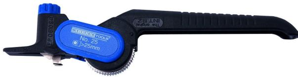
Der Außenmantelschneider No. 25 ist zum Abisolieren von Kabeln bis zu einer Mantelstärke von 5 mm konzipiert. Das Messer kann sowohl für Längs- als auch für Rundschnitte eingesetzt werden. Der Rundschnitt kann bei Kabeln ab einem Außendurchmesser von 25 mm durchgeführt werden. Das Schneiden der Außenisolation erfolgt durch kleine Hebelbewegungen und gleichzeitiges Andrücken der Verzahnung an die Isolation.
