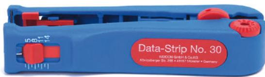
Mit dem Weicon Data-Strip können verschirmte Datenkabel und Sonderleitungen mit einem Durchmesser von 4 - 10 mm und Isolationsstärken von 0,2 bis 1,4 mm abisoliert werden. Durch das integrierte Stellrad lässt sich das Messer auf unterschiedliche Isolationsstärken einstellen, Folienverschirmungen anritzen und spielend leicht entfernen.
