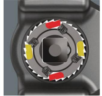
Gibt den robusten 30 Sägezähnen den feinmechanischen Effekt einer 60er Feilverzahnung mit 6° Rückholwinkel.
