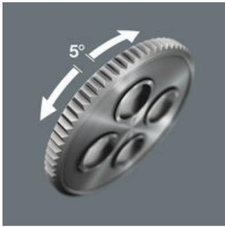
Die mit 72 Zähnen feinverzahnten Umschaltnarren haben einen niedrigen Rückschwenkwinkel von nur 5°. Der kleine Hub ermöglicht schnelles und präzises Arbeiten in allen Einbaulagen.
