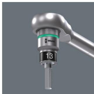
Die Klemmung der Außensechskant-Schraube im Steckschlüssel-Satz wird durch zwei federnde Kugeln und einen dauerelastischen hochfesten Schrumpfschlauch gewährleistet. Dieser wird durch einen vorderen Stahlbund wirksam gegen mechanische Verletzungen geschützt. Besonders hilfreich in schwer zugänglichen Arbeitsbereichen, wo man die zweite Hand nicht zum Festhalten der Schraube nutzen kann.
