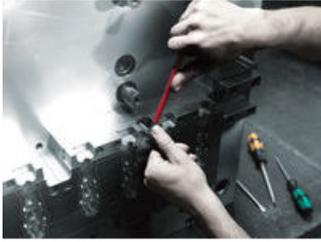
Wir haben die klassischen Winkelschlüssel einfach in Frage gestellt, weil sie beim Arbeiten viel zu oft die Schraubenkopfprofile verrunden. Mit der Folge, dass Schrauben nicht mehr betätigt werden können und man abrutscht. Wera Hex-Plus Werkzeuge haben größere Anlageflächen im Schraubenkopf. Die Kerbwirkung und damit die Deformierung der Schraube werden verringert. Gleichzeitig können bis zu 20 % höhere Drehmomente übertragen werden.
