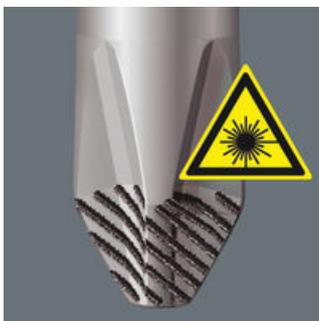
Mittels eng fokussiertem Laserlicht wird eine scharfkantige Oberflächenstruktur erzeugt. Die Laserbehandlung bewirkt eine Härte der Spure von bis zu 1000 HV 0,3. Wera Lasertip krallt sich im Schraubenkopf fest und verhindert das Herausrutschen aus dem Schraubenkopf. Bei Schlitz, Phillips und Pozidriv.
