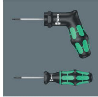
Die Wera Drehmomentindikatoren sind werkseitig mit den von führenden Hartmetallwerkzeugherstellern empfohlenen Werten voreingestellt. Diese Anzugswerte sind für TORX®, TORX PLUS® und Innensechskantschrauben auf die jeweilige Schraubengröße bezogen. Drehmomentindikatoren sorgen für sichere und leicht lösbare Schraubverbindungen. Präzision:  $\pm 10\%$
