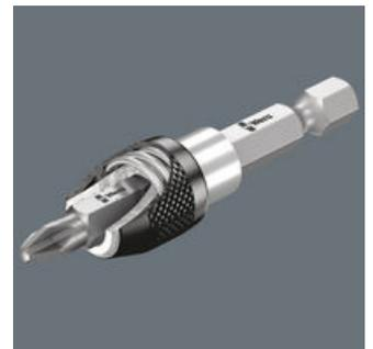
Wera Schnellwechselfutter stellen eine feste, wackelfreie Verbindung zwischen Halter und Bit her. Die Halter sind so konstruiert, dass beim Bitwechsel die äußere Hülse nach vorn geschoben wird und der Bit leicht eingesetzt und entnommen werden kann. In magnetischer Ausführung zum leichteren Ansetzen der Schrauben.
