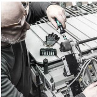
Viele Schraubverbindungen bei Montage – und Servicearbeiten müssen drehmomentkontrolliert angezogen werden, um die Sicherheit der Schraubverbindung zu gewährleisten und/oder Schäden an Schraube oder Werkstück zu vermeiden. Die einstellbaren Drehmomentschraubendreher von Wera sind hierfür die idealen Werkzeuge: Drehmomentbereich von 0,3 Nm bis 8,8 Nm, drei verschiedene Griffe, Messgenauigkeit von  $\pm 6\%$ , blitzschneller Bit-Wechsel durch die Bit-Aufnahme mit Rapidaptor-Technologie.
