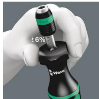
Von Hand verstellbar auf entsprechende Skalenwerte. Einfache Einstellung des benötigten Drehmomentwerts von Hand. Messgenauigkeit  $\pm 6\%$  nach Norm DIN EN ISO 6789. Deutlich hör- und spürbares Überrassten beim Erreichen des eingestellten Drehmoments.
