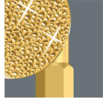
Die winzigen Diamantpartikel, die auf der Werkzeugspitze aufgetragen sind, beißen sich förmlich in der Schraube fest und sorgen für einen passgenauen und rutschfesten Sitz im Schraubenkopf. Durch diesen sicheren Sitz wird die Schraube geschont. Die Cam-Out-Kräfte (Ausrutschkräfte), die den Anwender zwingen, hohen Druck auf die Schraube auszuüben, werden erheblich reduziert.
