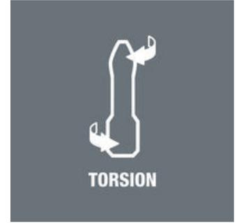
Torsion-Bits sorgen für die Abfederung von Drehmomentspitzen in der Torsionszone. Dadurch wird vorzeitiger Verschleiß vermieden, die Lebensdauer des Bits wird erhöht.
