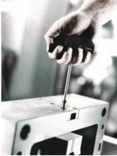
Der Querform-Griff kommt immer dann zum Einsatz, wenn es um die Übertragung hoher Anzieh- oder Lösemomente geht. Die ausschließliche Verwendung von Hartmaterial in Kombination mit großen Anlageflächen in der Hand sorgt für effiziente, formschlüssige Übertragung der Kraft.
